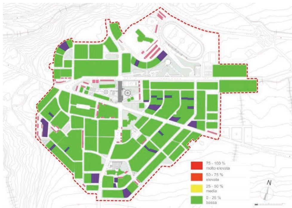
Figura 2 | Nuova Conza della Campania (Av) - Indice di vulnerabilità sismica complessiva risultante dall'applicazione del metodo DPC-GNDT, in viola, non riportato in legenda, sono stati evidenziati gli edifici pubblici per i quali non è stata valutata la vulnerabilità. Fonte: Elaborazione degli autori.
