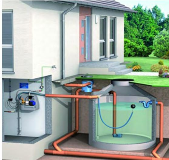
Figura 1 | Esempio di detenzione attraverso l'uso di serbatoi interrati.
