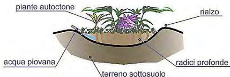
Figura 2 | Esempio di sistema di detenzione attraverso l'uso di giardini.
